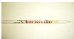
北川式ガス検知管 測定範囲: 0.05～4.0ppm
