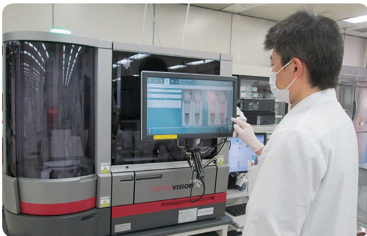
全自動輸血検査装置 VISION で検査結果を確認しているところ
