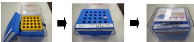
適温になっているスチールBOXに青色のカバーをして採血した検体を挿入して下さい。冷凍庫から取り出したスチールBOXは、8～10時間氷冷温度を維持します。
