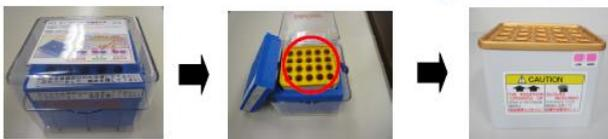
当検査センターよりキューブクーラーが届きましたら、スチールのBOX（赤丸）部分を取り出し、冷凍庫（ $-20^{\circ}\text{C}$ ）で10時間以上蓄冷してください。
