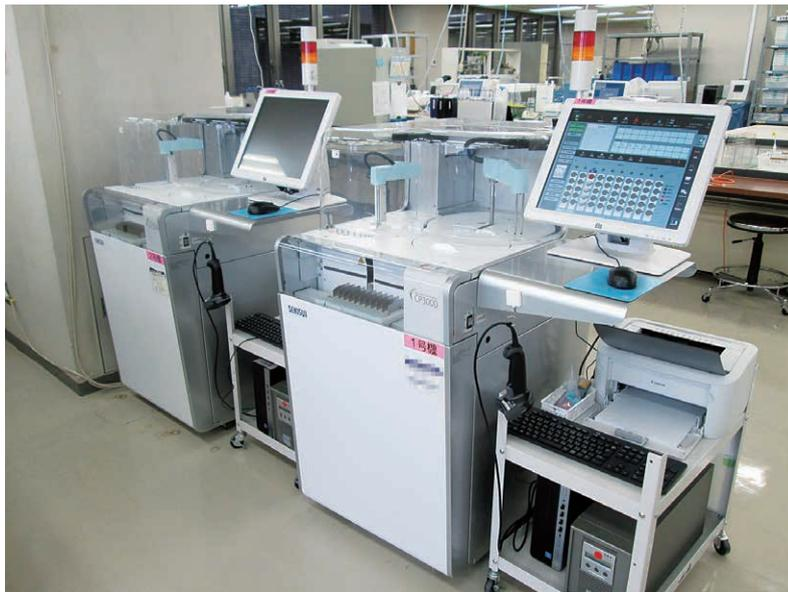
以前は、CP2000 1台での運用でしたが、CP3000からは2台での運用となりました。これにより、検査機器に何らかのトラブルが生じた場合でも、もう1台で検査を行うことが可能となり、修理が完了するまで検査が中断することがなくなりました。
