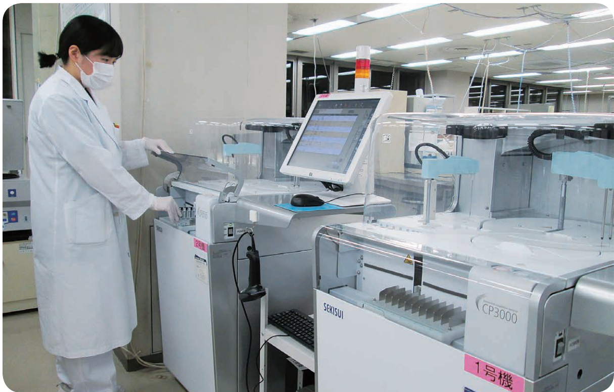
血液凝固自動分析装置 CP3000 で検査を行っている様子
