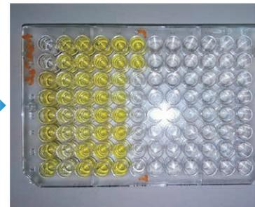
反応停止液を入れ、マイクロプレートリーダーで測定する
