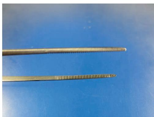
写真2 ピンセット先の拡大、溝付き
