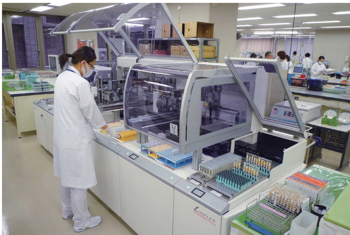
新規自動分注機<日立アロカ検体前処理システム LabFLEX >の導入(※次号に機器紹介記事掲載予定)
