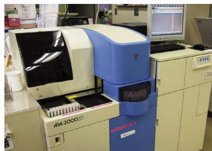
平成26年 4月 1日から所内導入した BNP 測定機 (全自動エンザイムイムノ アッセイ装置 AIA-2000)
