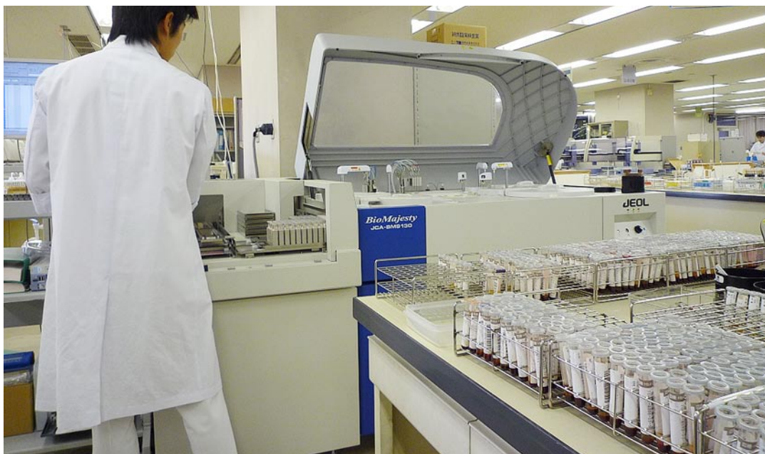
自動分析装置 BioMajesty JCA-BM9130 にて血糖および HbA1c を分析している様子(自動・生化学係にて)
