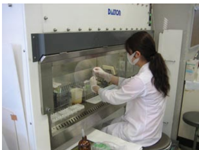
検体塗抹の様子 検体の塗抹は安全キャビネット内で行います。
